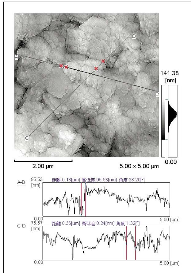
Fig.3 コート紙の断面形状の測定
