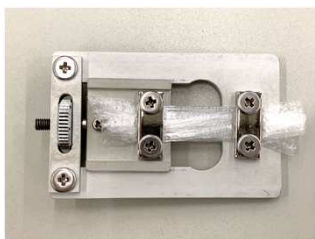
写真1 繊維試料アタッチメントに荷造り紐を固定した様子
