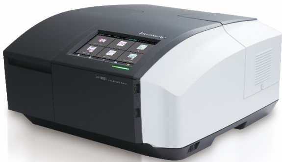
図4 紫外可視分光光度計 UV-1900i
