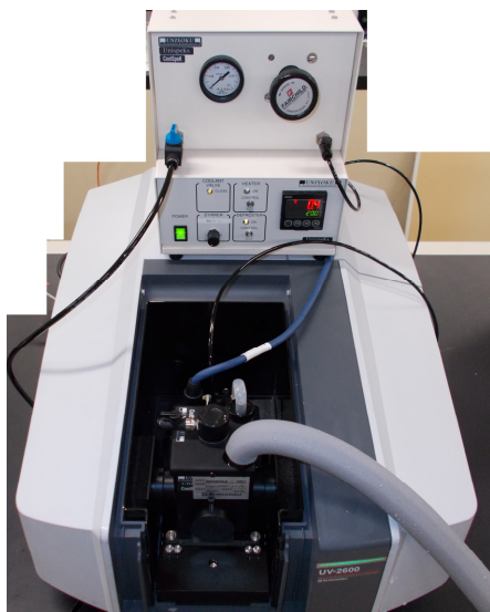
図 1 UV-2600 に CoolSpeK を取り付けた様子
