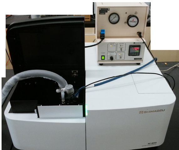
図4 RF-6000にCoolSpeKを取り付けた様子
