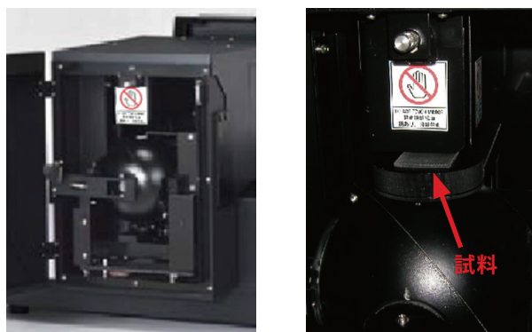
Fig. 3 ISR-1503 の内部 (左) および試料を設置した状態 (右) Left: Inside of ISR-1503, Right: Inside after Setting a Sample
