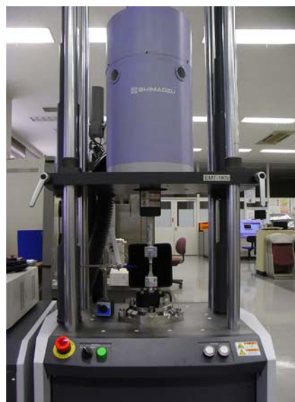
Fig.1 疲労・耐久試験システム Fatigue and endurance testing system
