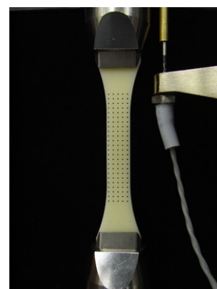
Fig.1 グリップされた引張り試験片 Gripped specimen
