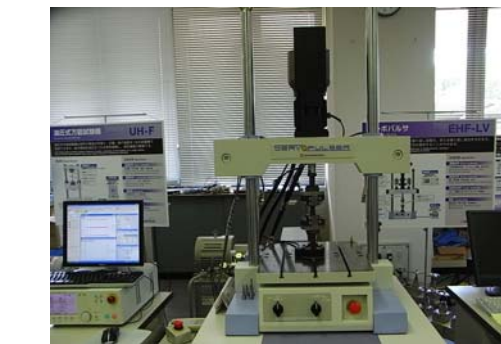
Fig.1 島津サーボパルサ EHF-LV20kNX 形 外観 Overview of SHIMADZU Servopulser EHF-LV20kN
