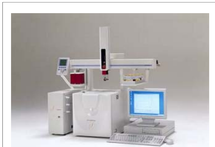
図4 におい識別装置 FF-2A 外観
