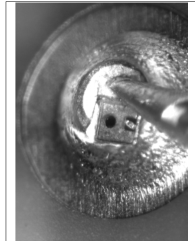
図 4-2 シリコンチップ剥離試験後写真
