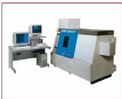
Fig.1 マイクロフォーカス X 線 CT システム SMX-225CT-SV3 外観 Overview of Micro-focus X-ray CT system (Model SMX-225CT-SV3)
