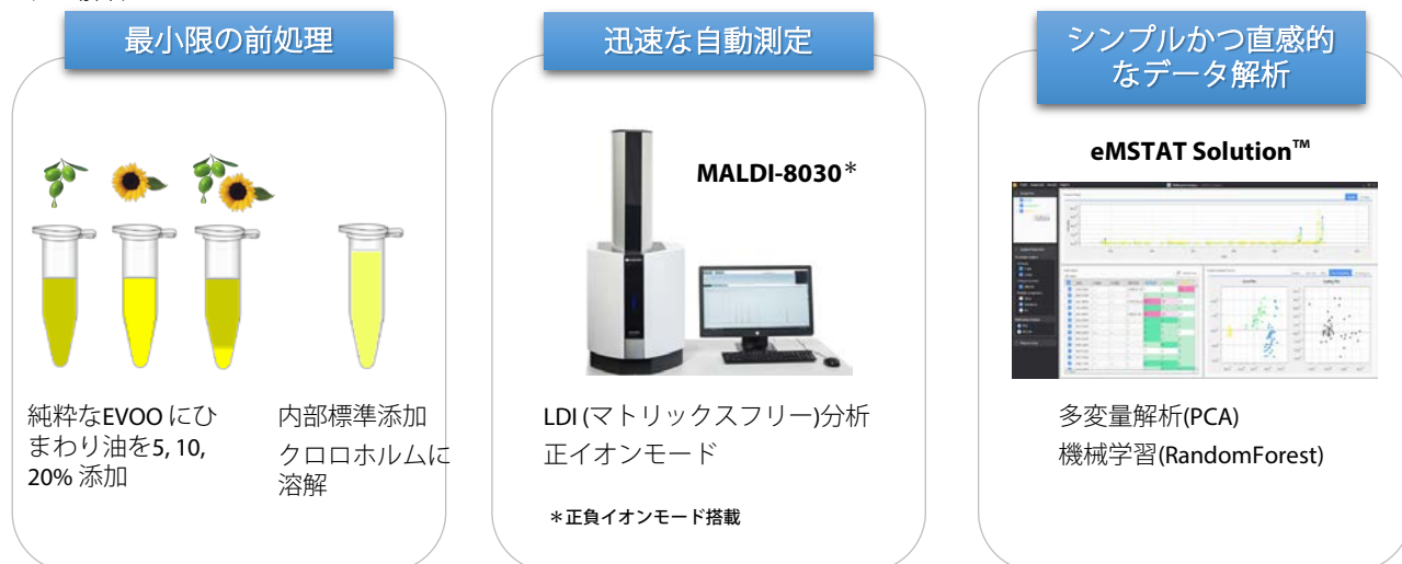
図 1 偽和処理したエキストラバージンオリーブオイルの分析ワークフロー
