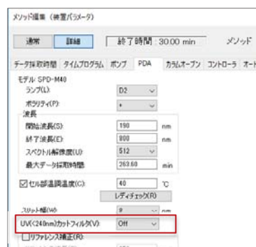
図 3 SPD-M40 の UV カットオフフィルタ機能設定画面
