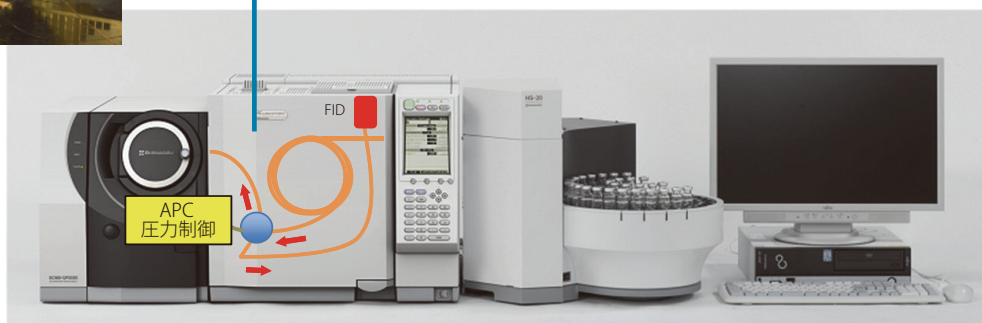
Fig. 1 GCMS-QP2020/FID 検出器分岐システム System Image
