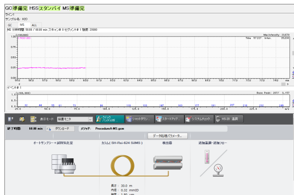
図8 LabSolutions™ GCMS 分析画面
