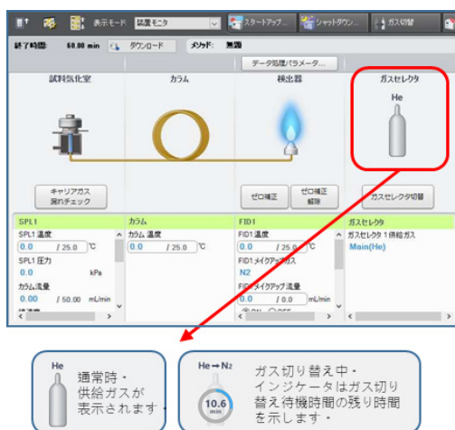
図4 ガスセレクトを用いたキャリアガス切り替え機能の画面
