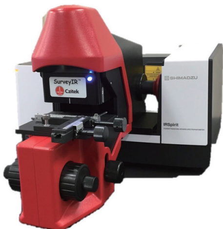
図 1 試料室設置型赤外顕微システム (IRSpirit-T / SurveyIR)
