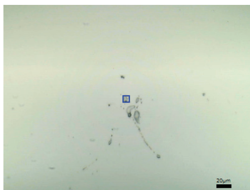
Fig. 1 微小異物の顕微鏡画像 (青枠は□ 10 μm) Microscope image of Contaminants
