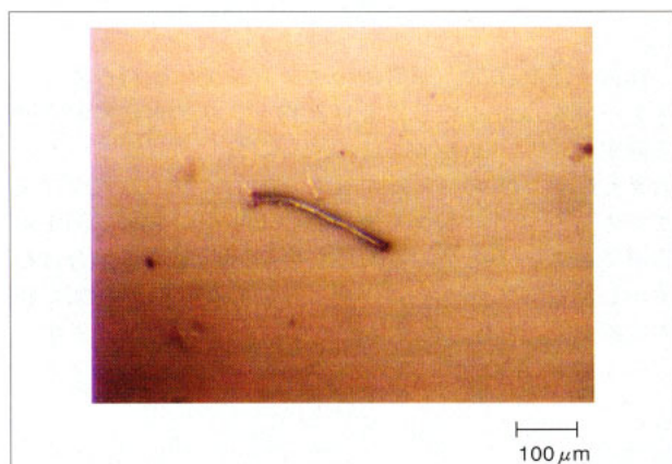
Fig.3 フィルタに付着した繊維の拡大写真 Micrograph of a Fiber Imbedded in Filter
