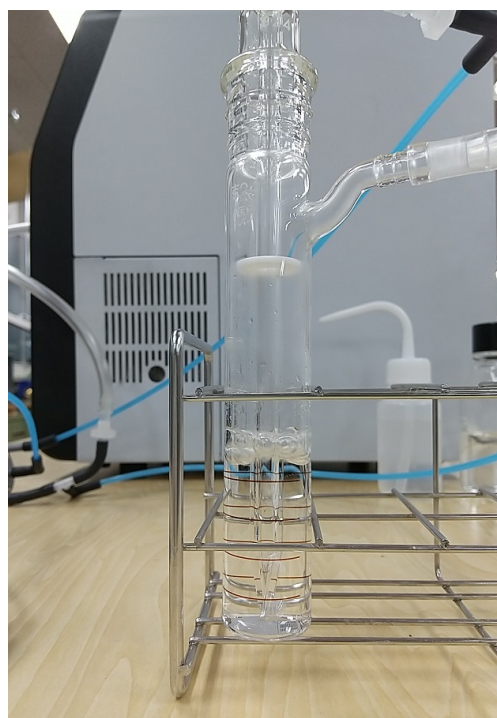
図3 インピンジャー内の通気の様子
