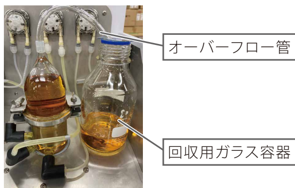
Figure 4: ヨウ化ナトリウム水溶液が回収される様子
