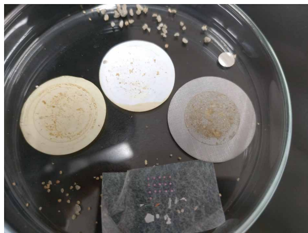
Figure 5: 回収溶液を濾過処理したサンプル
