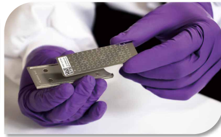
Fig. 5 FlexiFocusアダプ ターとインサート。 アダプターには磁石 が組み込まれており、 インサートを正しい 位置に保持します。
