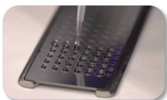
Fig. 1 FlexiFocus: 化学的に処理された表面によりサンプル液滴の位置が固定される。
