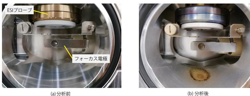
Fig. 8 連続分析後のイオン源汚染状況
