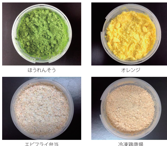
Fig. 4 予冷式ドライアイス凍結粉碎にて粉碎した試料
