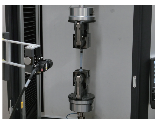
図3 引張試験風景
