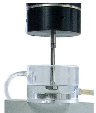
恒温水浸漬装置は、生体材料やインプラントの試験に最適です。
