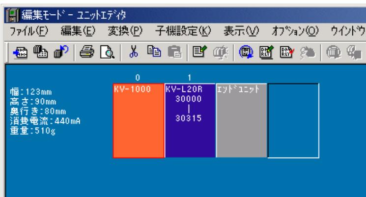
ここで「KV - L20R」のユニットをクリックして選択すると、パソコン画面右のユニット構成図に設定項目があらわれますので左下図のように設定します。リレー、DM は自動割付 (F5) した値です。
