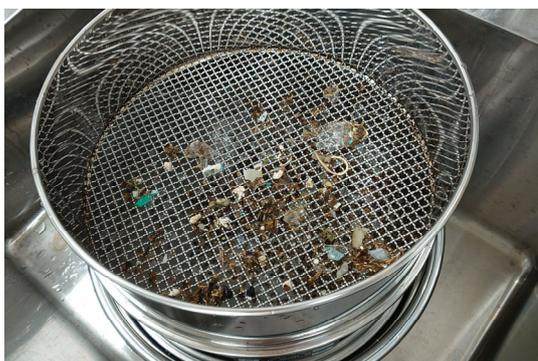
(例) 評価対象となる0.3 mm~5 mmのプラスチックを採取するために篩にかけます。
