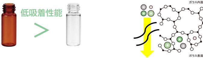
TORAST-H™ Glass Vialでは、透明・褐色ともにガラス中の金属が取り除かれているため、従来の透明・褐色ガラスバイアルを凌駕する低吸着性能を示す。
