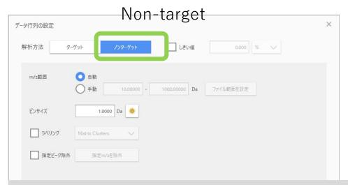
ノンターゲットはスペクトルから一定のm/z幅で信号強度を切り出します。
