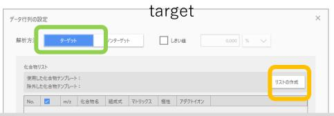
ターゲットは特定のm/z値と許容幅を指定します。 "リストの作成"を押すと"化合物テンプレート"か らリストを作成できます。
