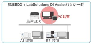
注3) 島津装置制御PCには、島津装置は1台しか接続できません。 注4)クロマト装置など一部の装置は対応していません。
