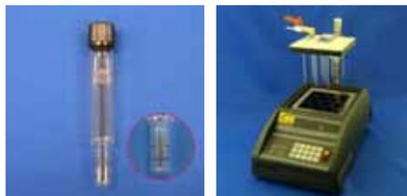
試験管(秤量線つき)と窒素吹き付け濃縮装置の例
