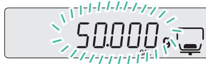
質量が点滅表示したら、分銅を載せます。
