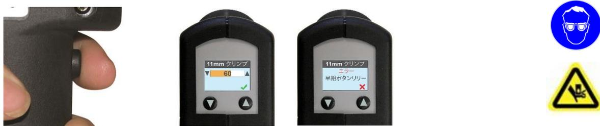
適切な巻き締め強度になるように設定し、クリンプ後のキャップ形状を確認してください。クリンプ強度は ▼ と ▲ を押して調整します。キャップが簡単に回るようであれば、▲ を 2~3 回押して締め付けをきつくします。クリンプ強度が強い場合は、▼ を押して強度を弱めます。
