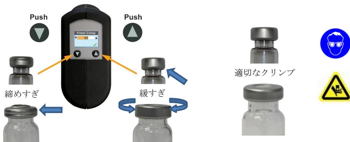
バイアルネックの下側まできれいにクリンプされていることを確認します。また、キャップが簡単に手で回せないことを確認します。簡単に手で回ってしまう場合はクリンプ強度を調整してください。
