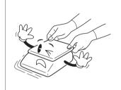
天びんを電磁気が発生している 外部の装置から離してください。
