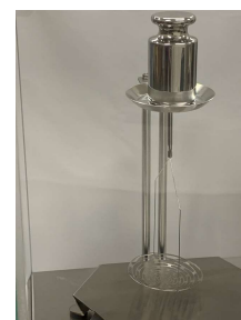
外部分銅を載せた様子
