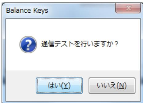
通信テスト画面が表示されますので、接続されている電子天びんにて「PRINT」キーを押し、計測値が表示されることを確認してください。複数の電子天びんを接続している場合は、画面はそのままで順次電子天びんから送信してもらえば結構です。
