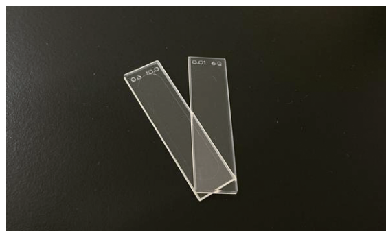
図7 貼り合わせタイプのセル（光路長0.01 mm）
