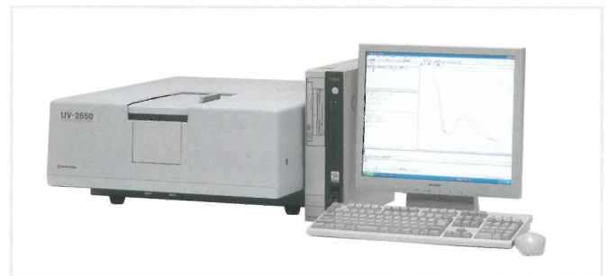
図7 島津紫外可視分光光度計UV-2550
