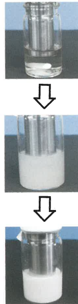
図3 プローブ型ATR-FTIR分光光度計を用いる (±)-NNMe 3 の結晶化プロセスの追跡
