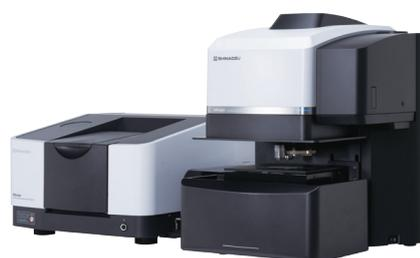
図5 IRXrossと接続したAIRsightの外観
