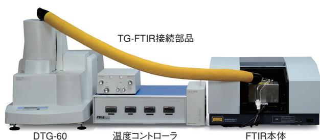
Fig.1 TG-FTIRのシステム外観図
