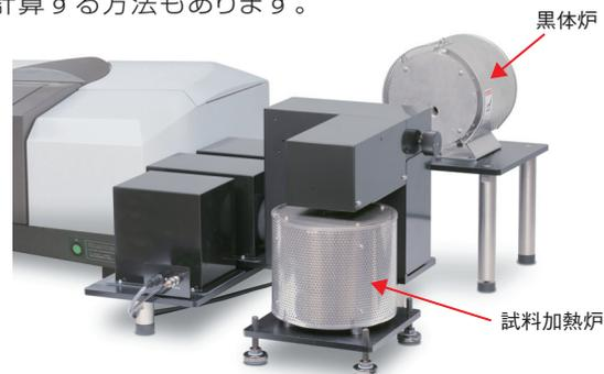
Fig.7 放射率測定システムの概略図
