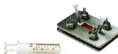
Fig.2 液体用気密セルの外観図
