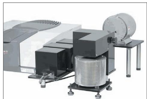
図2 分光放射率測定システムの外観
