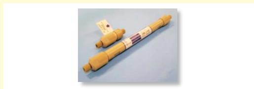
図5 PEEK製クロマトグラフィー管
