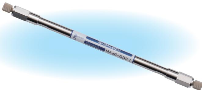
“Shim-pack MAqC-ODS I” は、金属を含有させたシリカゲルにオクタデシルシリル基を導入した逆相カラムです。金属の含有により、ODS による疎水性相互作用に加え、陽イオン交換作用を有します。
