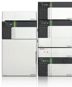
超高速液体クロマトグラフ (UHPLC) は、微粒子充填剤カラムを使用できるようにシステム耐圧を従来の HPLC からより高めたシステムです。“Nexera Quaternary” は、世界最高のシステム耐圧 130 MPa と幅広い流量域に対応した UHPLC “Nexera” をベースに、4 液のグラジエント溶離や移動相切替に対応したシステムであり、汎用分析から超高速分析、分析条件開発からルーチン分析まで幅広く利用できる “Nexera” シリーズの新しいスタンダード UHPLC です。
