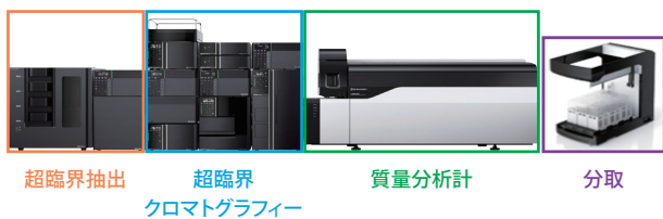
図1 弊社保有のSFC装置構成
