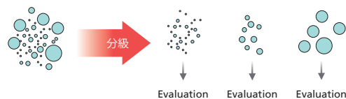
図3 分級計測の概念図
