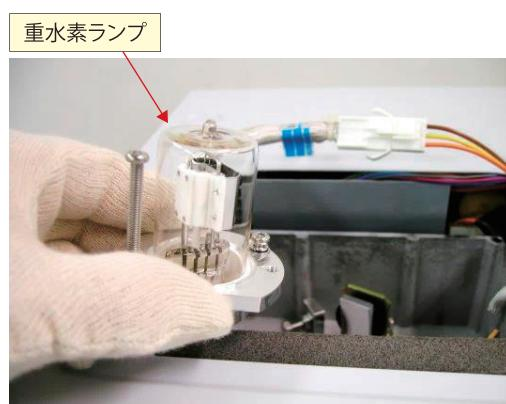
図5 ランプ交換の例（吸光光度検出器）
